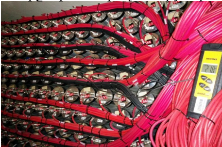
Նկար 1.1 SHMS էլեկտրամագնիսական կալորիմետրի տեսքը և նրա մալուխների միացումը ետեւից (ձախից), և ազդանշանների միացման սխեման fADC-ներին (աջից):
