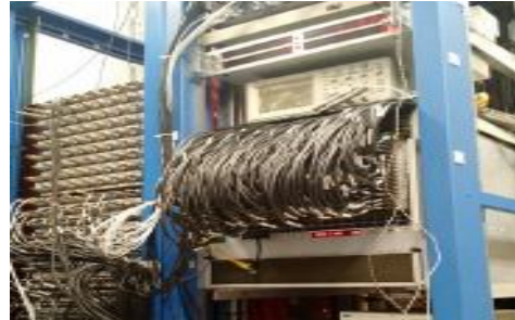
Նկար 1.1 SHMS էլեկտրամագնիսական կալորիմետրի տեսքը և նրա մալուխների միացումը ետեւից (ձախից), և ազդանշանների միացման սխեման fADC-ներին (աջից):
