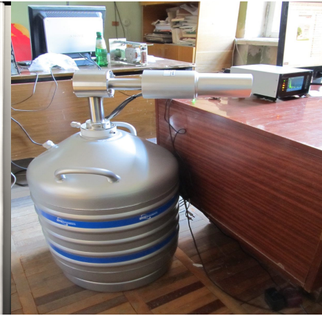
Նկ. 1. GCD-20180 կոաբսիալ դետեկտորի չափսերը և արտաքին տեսքը
